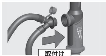
ジョイントは、手で締め付けてください。損傷の原因になるため、工具などで締め付けしないでください。
